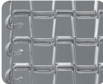
Esta banda tiene bordes cerrados. Las varillas de conexión son curvas hacia atrás para agarrar la estaca, extenderla hasta alcanzar su prolongación máxima y bloquearla de manera segura en su lugar. Nunca se produce estricción. Asimismo, las varillas cerradas forman una barra de protección contra el desgaste a lo largo de los laterales de la banda para brindar resistencia y evitar el daño.
