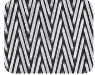
**Bandas de balanceado compuesto.** Estas bandas tienen espirales derechos e izquierdos colocados cerca unos de otros para brindar un entramado denso y uniforme. Son excelentes para transportar productos muy delicados y pequeños, así como también elementos inestables o grandes. Las bandas de balanceado compuesto se utilizan ampliamente para el horneado de galletitas, galletas y refrigerios.
