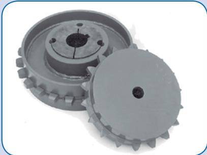
**Acero maquinado.** Dura hasta cinco veces más que los engranajes fundidos, concéntricos, con maquinado de precisión, cortados de barras sólidas, templados a la llama y manualmente desbarbados... y debido a que están acañados en la línea central del diente, siempre se adaptan. Los diseños de bloque cónico ofrecen una instalación y alineación simples.
