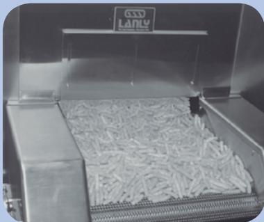
Los engranajes MTS y la malla transportan bocaditos de queso a través de este horno Lanly altamente efectivo.
