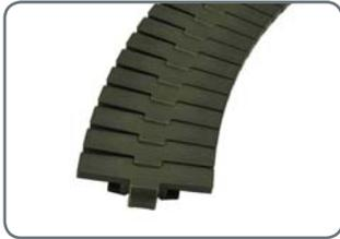
■ **DK2.** Se trata de un plástico de super baja fricción con Delrin y Kevlar. Se usa en vidrieras y en puntos donde la fricción es muy alta. Puede trabajar en seco con envases de vidrio y esta ampliamente usado y aceptado en el sector del embotellado.
